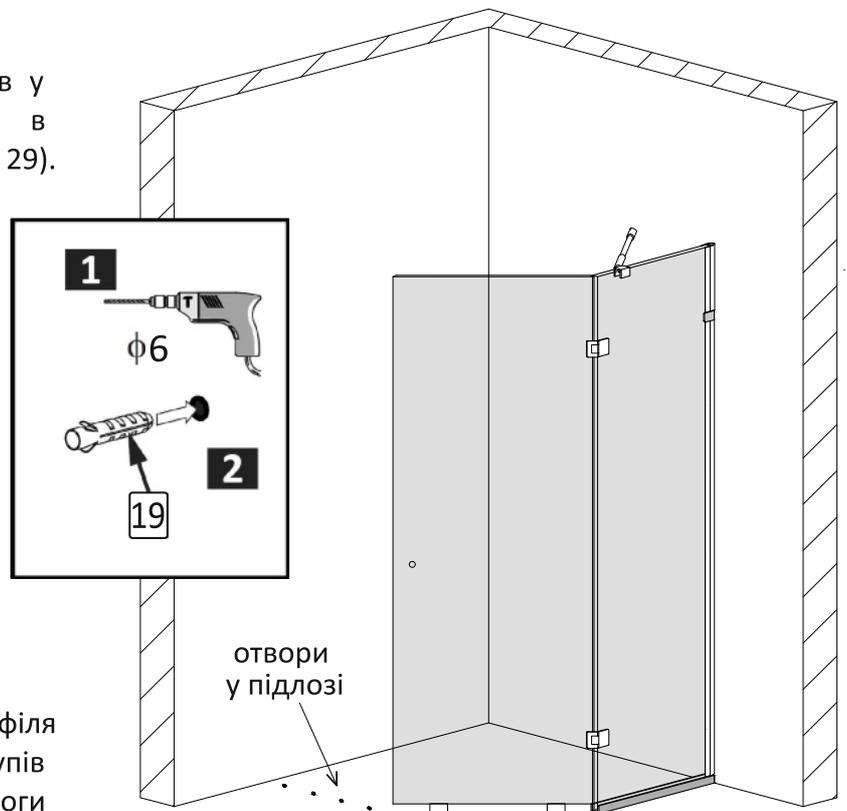
5.8. Нанесіть на нижню сторону профіля прозорий силікон. За допомогою шурупів №20 закріпіть профіль до підлоги (мал. 30).
